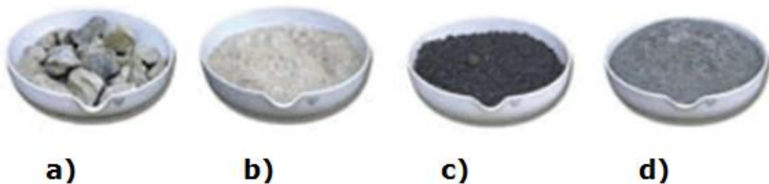
Figura 10 – Matéria-prima: a) Marga; b) Crú; c) Clínquer; d) Cimento.
